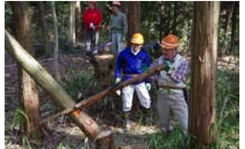
フェリングレバーで木を回転させる処理法
